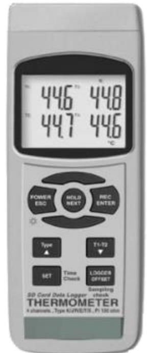
**Nota: Para alimentar o instrumento, utilizar pilhas ou adaptador, nunca utilizar os dois juntos.**
